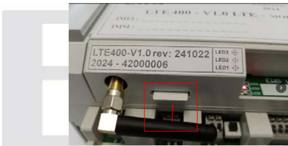
Slika 2.1.1. Pozicija otvora za SIM karticu
